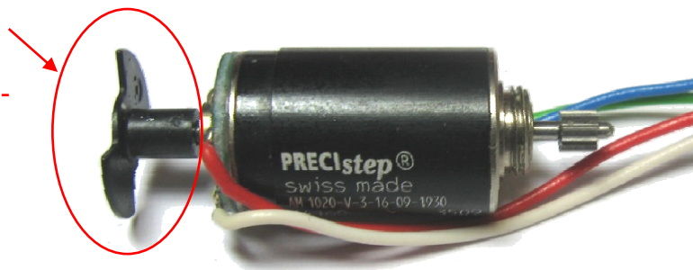
Image 1 : moteur avec une pièce plastique sur l'arrière de l'arbre utilisé pour une solution de codeur optique personnalisé.
